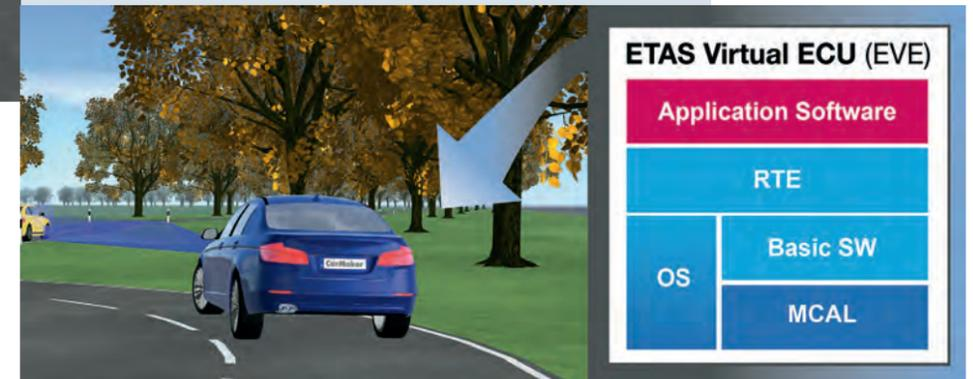
chen die Wiederverwendung existierender Methoden und Artefakte. Auch kann die Steuergerätesoftware im Systemkontext erprobt und im Zusammenspiel mit Umgebungs- und Komponentenmodellen validiert werden, lange bevor Hardware-Prototypen verfügbar sind. Die Steuergerätesoftware erreicht so früh einen hohen Reifegrad, was den Entwicklern Zeit für die Entwick-
