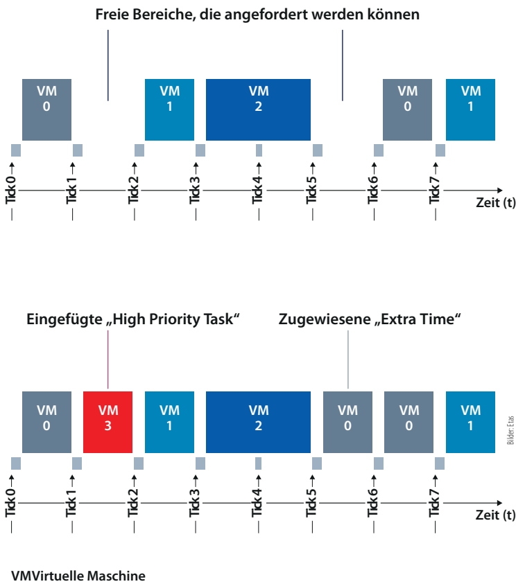
Bild 2: Zeitmanagement in einem Applikations-Core. Zusätzlich angeforderter Laufzeitbedarf wird in die freien Bereiche vom Hypervisor eingefügt.
