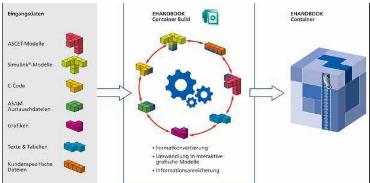
Abbildung 2: Das Werkzeug E-Handbook Container Build generiert die Steuergerätedokumentation, die im Container rechts in komprimierter Form enthalten ist.
