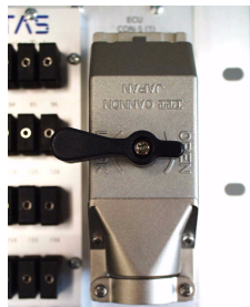
Abb. 3-2 Befestigung des DLM5-260 Steckverbinders (Beispiel)
