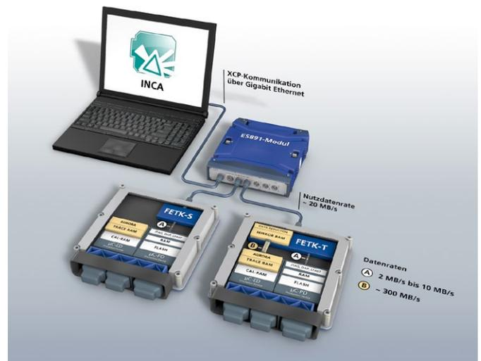
FETK は実車内またはテストベンチにある ECU のデータを、マイクロコントローラインターフェース経由で取得し、そのデータを ES891 モジュールに転送します。そして、これらのデータは他のソースからのデータと一緒に ES891 モジュールから PC またはノートパソコンに転送され、INCA 環境でオンライン処理されます。この過程で、データは FETK から INCA-PC までの経路全体にわたって Gigabit Ethernet 通信で転送されます。これと同じ転送経路により、ECU 内のパラメータを INCA でユーザーが変更したり、自動的に変更したりできます。
