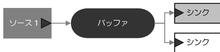
図 3-25 接続：1 つのソースから複数のシンクへタイミングをずらして入出力
