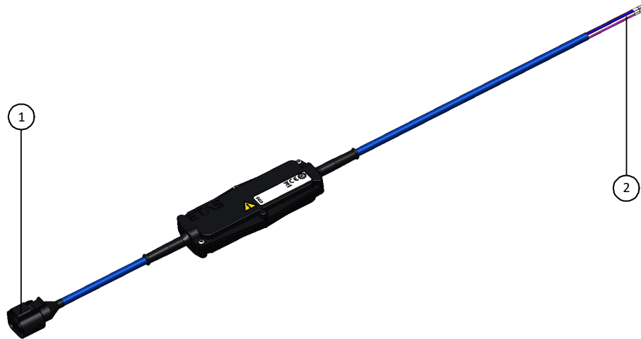
Abb. 4-2 Anschlüsse des Intelligenten Lambdasonden-Kabels
